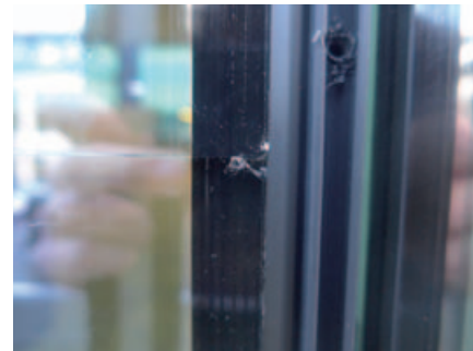
▲ Schade aan de rand van het glas is vaak een oorzaak van breuk.
